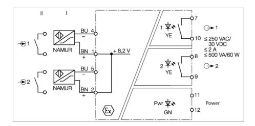
Двухканальный переключающий усилитель с гальванической развязкой IM12-22EX-R имеет искробезопасные входные цепи.
