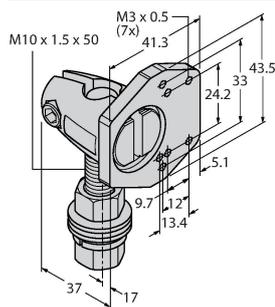
Кронштейн монтажный, поворотный, нерж. сталь, для датчиков серии Q4X/Q3X, резьба M10 x 1,5
