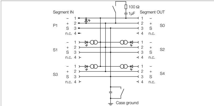
Le répartiteur à quatre canaux du type JBBS-49SC-M413/3G est conçu pour le FOUNDATION™ fieldbus.
