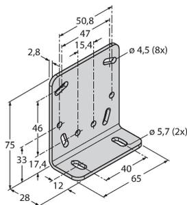
bride de fixation, à angle droit, acier inoxydable, pour montage latéral pour les détecteurs de la série LE250/550
