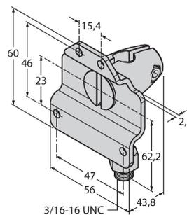
équerre de fixation, orientable, acier inoxydable, pour les détecteurs de la série LE250/550
