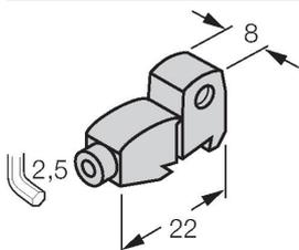
Soporte de montaje para el montaje de sensores de campo magnético en los cilindros perfilados con guía en cola de milano exterior; para todos los diámetros del cilindro, material: Aluminio anodizado
