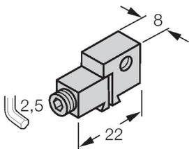
Soporte de montaje para el montaje de sensores de campo magnético en cilindros de ranura en cola de milano
