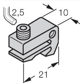
Soporte de montaje para el montaje de sensores de campo magnético en los cilindros perfilados (IMI Norgren); diámetro del cilindro: 32...100 mm; material: Aluminio anodizado
