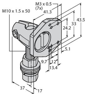
Soporte de montaje, girable, acero inoxidable, para sensores de la serie constructiva Q4X/Q3X, rosca M10 x 1.5
