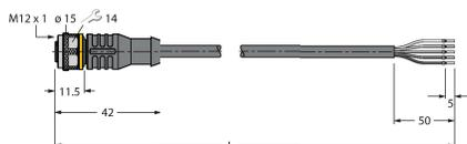
Cable de conexión, conector hembra M12, recto, 5 polos, longitud de cable: 2m, material de la funda: PVC, negro; homologación cULus; disponibles otras longitudes de cable y variantes, véase [www.turck.com](http://www.turck.com)
