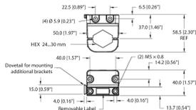
Soporte de montaje; llave de tamaño variable de 24 a 30 mm; placa de etiquetado extraíble de 20 x 9 mm
