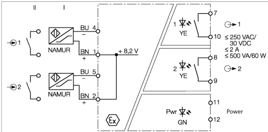
Der 2-kanalige Trennschaltverstärker vom Typ IM12-22EX-R ist mit eigensicheren Eingangskreisen ausgestattet.
