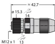
Konfektionierbare Kupplung, M12 x 1, gerade, 4-polig, Schneidklemmanschluss, Leitungsdurchlass 4.0 bis 5.1 mm, Adernquerschnitt/ Klemmvermögen 0.14 bis 0.34 mm<sup>2</sup>, Kunststoffgehäuse, Metallüberwurfmutter
