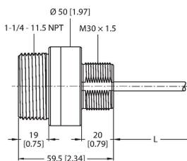
Ultraschallsensor, Reflexionstaster, 3m Reichweite, serielle Schnittstelle zum Anschluss an DX80 Knoten
