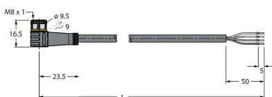
连接线缆, M8母头接插件, 弯式4针, 线缆长度2 m, 护套材质PUR, 黑色; cULus认证
